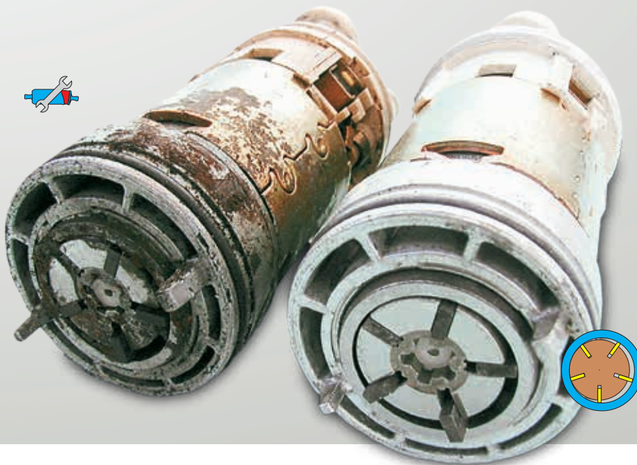
صورة ٣٦: ضرر ناتج عن الماء في مضخة ذات خلايا منجحة على اليمين للمقارنة، مضخة وقود تم قطع عدد مماثل من الكيلومترات بها، ولم تتعرض للماء.
