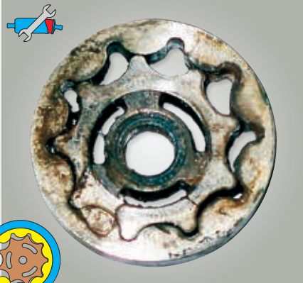
صورة ١٩: مضخة مسدودة (حلقة Trochoiden) ذات حلقة مسننة E3T
