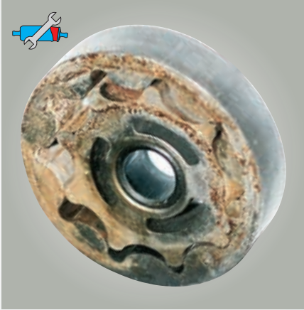
صورة ٥٣: للمقارنة: مضخة Trochoiden بها صدأ. في هذه الحالة تتعذر حركة الأجزاء.
