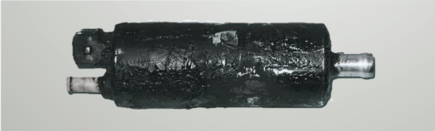
صورة ٦٥: مضخة خطية تُستخدم كمضخة خزان
