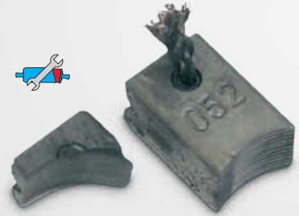
صورة ٦٢: ملامسات التجليخ عند حوالي ١٥,٠٠٠ كم على اليسار: تأكل مبكر؛ على اليمين: حالة عادية مع هذا المعدل للمسافة المقطوعة
