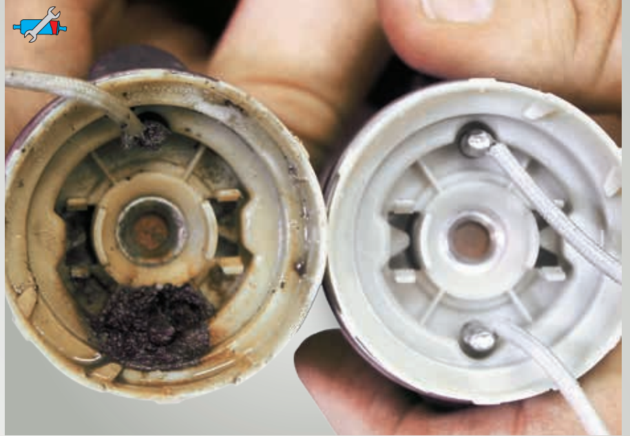
صورة ٤٦: على اليسار: ملامسات كهربائية عليها صدأ، على اليمين: حالة جديدة
