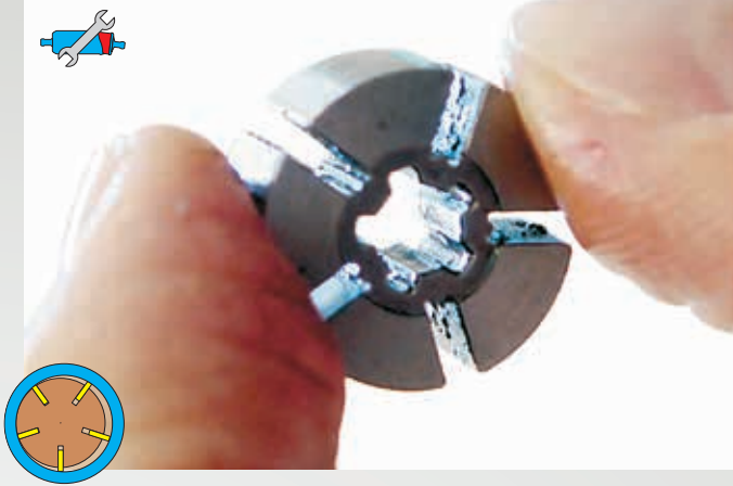
صورة ٣٠: اتساح مضخة ذات خلايا مجنحة العضو الدوّار متسخ بشدة لدرجة أن الأجنحة المختلفة (مخلوطة من هنا) لم يعد بإمكانها التحرك. المضخة "تدور" فعلاً باستمرار، ولكنها لا تضح شيئاً.
