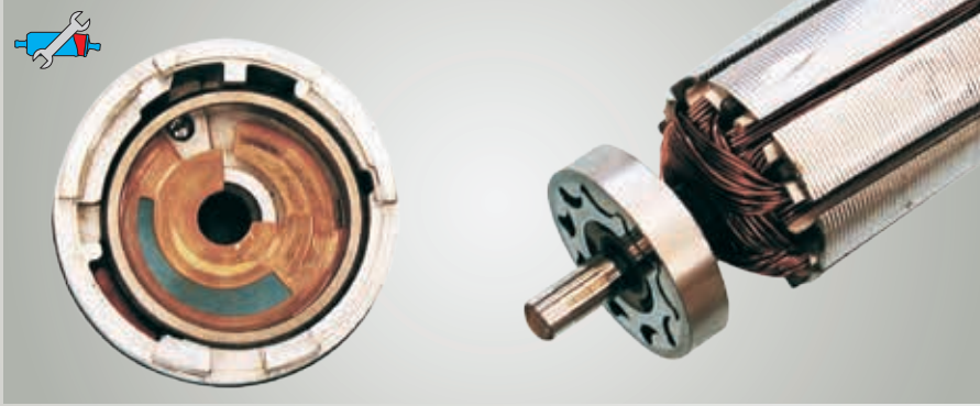
صورة ٣٨: للمقارنة: مضخة ذات حلقة مسننة E3T - في حالة جيدة رغم عملها لوقت طويل
