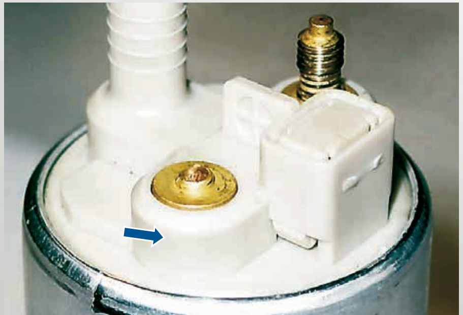
صورة ٧٥: ضرر بالملامسات الكهربائية ناتج عن عنف
