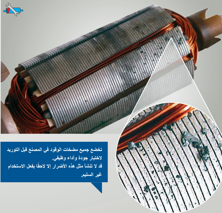
صورة ٨٠: تلف المغناطيس المستديم (العضو الساكن)
