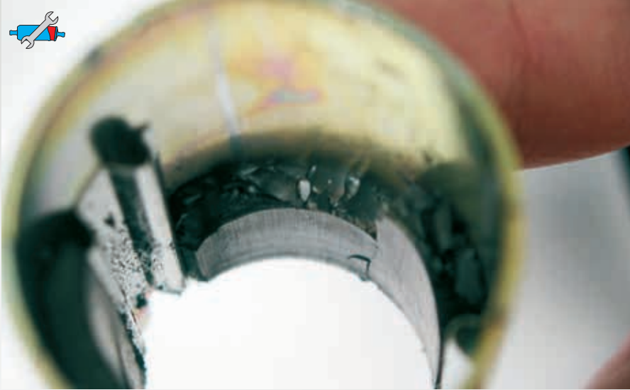
صورة ٨٠: تلف المغناطيس المستديم (العضو الساكن)
