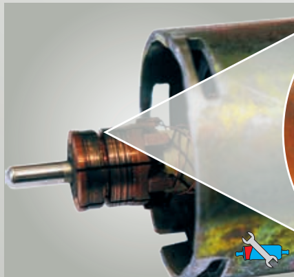
صورة ٦٣: قضيب تجليخ تالف لمحول القطب حدث هنا "تجليخ" للنوابض التي تضغط الفرشاة الكربونية على محول القطب بعد احتراق الفرشاة الكربونية.
