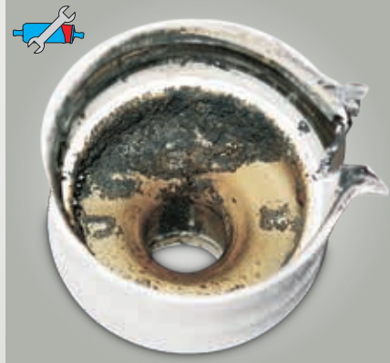
صورة ١٨: مقطع من جسم مفصول لمضخة ذات حلقة مسننة E3T - مسدودة بفعل الرواسب
