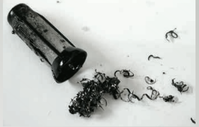
صورة ٢٩: شطايا في فلتر الترشيح وصلت هنا شطايا معدنية إلى خزان الوقود أثناء إجراء أعمال على نظام الوقود. تتسبب الشطايا حادة الحواف في الإضرار بفلتر الترشيح. من خلال ذلك يمكن أن يصل اتساح إلى المضخة ويعوق المضخة.
