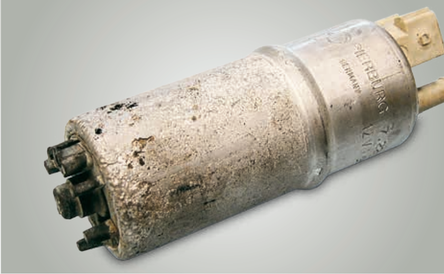
صورة ٧٢: الصدأ الناتج عن التلامس في حالة ازدواجات معدنية خاطئة
