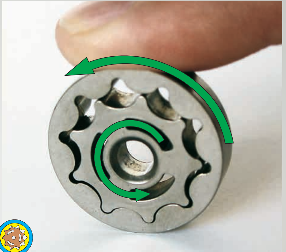
صورة ٥٢: أجزاء مضخة Trochoiden يجب أن تدور داخل بعضها بسهولة ويسر
