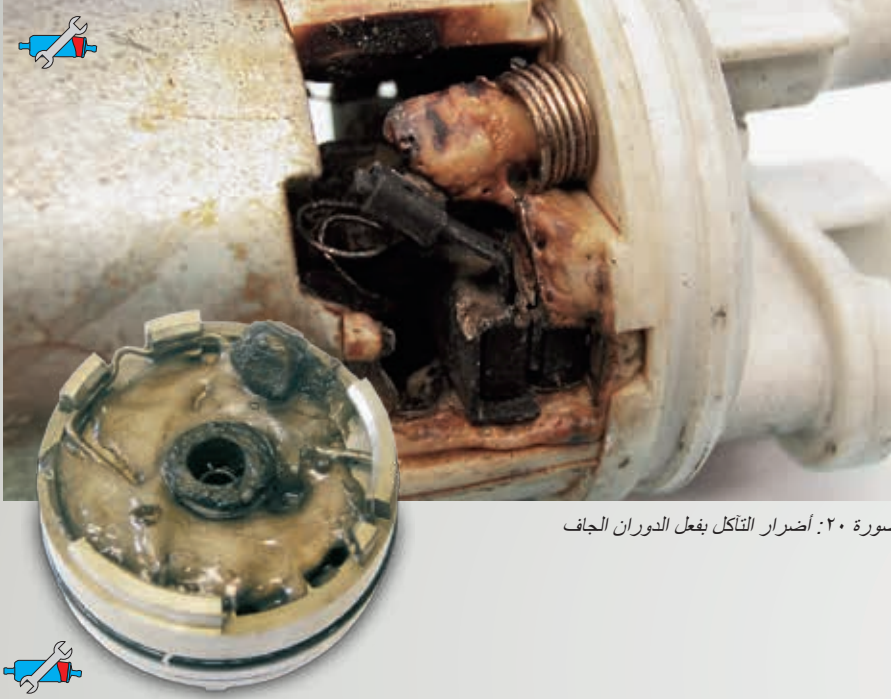
صورة ٢١: من خلال الدوران الجاف، انصهرت الأجزاء البلاستيكية في مضخة الوقود
